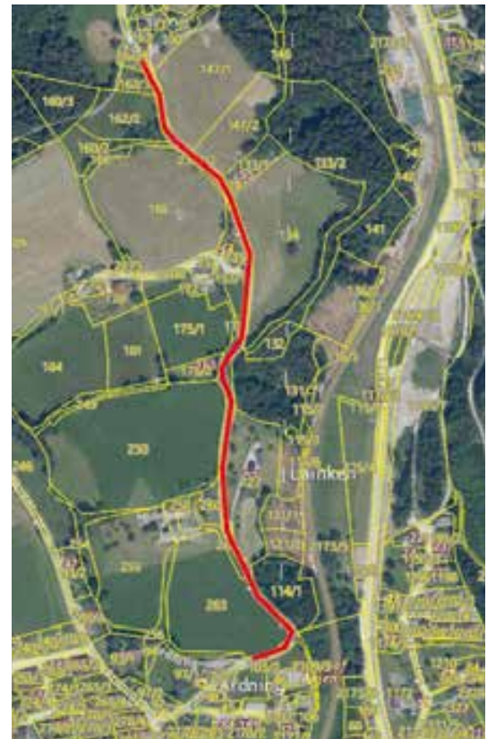
Erneuerung der Versorgungsleitung im Zuge der Glasfaserverlegung zum Hochbehälter Brandl (Kostenteilung Grabarbeiten)
